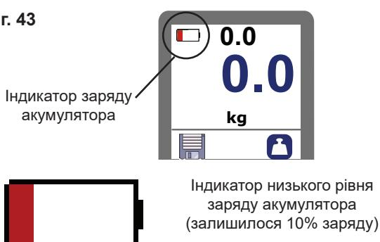
Індикатор заряду акумулятора на пульті ручного керування попередить про низький заряд акумуляторів підйомника *Sara Flex*, і в такому випадку двічі на хвилину лунатиме звуковий сигнал. Завершіть переміщення й зарядіть акумулятор.
