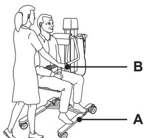
Опустите гигиеническое кресло-подъемник Calypso на такую высоту, при которой пациент сможет поставить ноги на площадку для стоп (A). При транспортировке используйте рукоятки для транспортировки (B).
