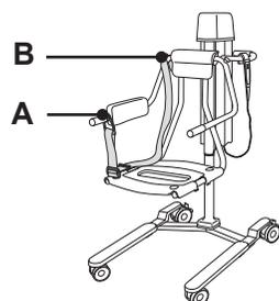
Снимите ремень безопасности, ослабив его и сняв один из концов либо с рукоятки для транспортировки (А), либо с ручки крепления ремня (В).
