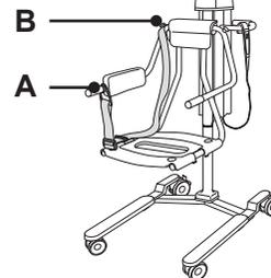
Снимите ремень безопасности, ослабив его и сняв один из концов либо с рукоятки для транспортировки (А), либо с ручки крепления ремня (В)
