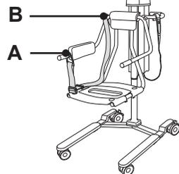
Retire o cinto de segurança, desapertando e retirando uma das extremidades do manípulo de transferência (A) ou do botão (B).
