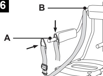
Pripravite varnostni pas na transportno ročico (A). Drugi konec varnostnega pasu pritrdite na gumb (B).
