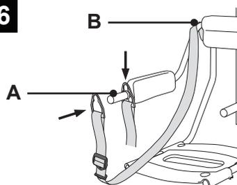
Attacher la sangle de sécurité à la poignée de transport (A). Attacher l'autre extrémité de la sangle de sécurité au bouton (B).
