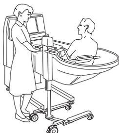
Abaisser le siège du fauteuil élévateur d'hygiène Calypso de sorte qu'il repose sur le fond de la baignoire. Enlever la sangle de sécurité.
