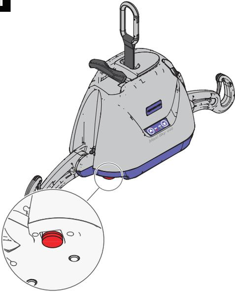
El operador puede cortar la energía eléctrica en cualquier momento pulsando el botón de emergencia rojo en forma de seta situado debajo de la grúa.
