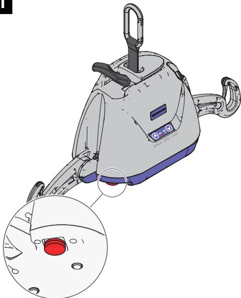
Der Lifter kann jederzeit von der Spannungsversorgung getrennt werden – hierfür wird der rote pilzförmige Bedienknopf unter dem Lifter gedrückt.
