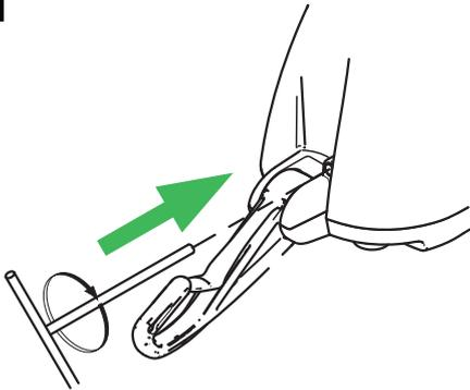
Das Spezialwerkzeug in die Öffnung einsetzen. Zum Absenken des Pflegebedürftigen im Uhrzeigersinn drehen. Das Spezialwerkzeug dreht den Motor direkt, sodass der Pflegebedürftige langsam herabgelassen wird.
