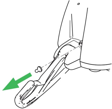
Entfernen Sie die schwarze Kunststoffkappe an der Seite des Lifters.
