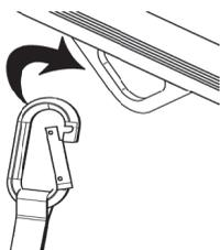
将竖钩挂到滚轮上，然后将移位机移到患者上方。
