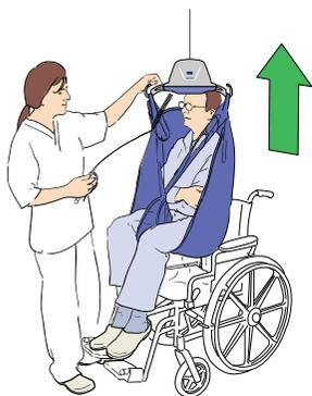
如果要提升患者，请按下手持控制器上的“升高”按钮。移动患者之前请升高设备，直到患者臀部完全离开轮椅臂支架、浴缸或床铺的顶部。
