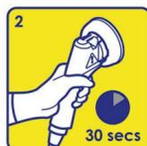
Nel caso di vasca con idromassaggio: collocare la doccetta di disinfezione nella porta di iniezione. Tenere premuto il grilletto. Dalle bocchette dell'aria/ugelli deve fuoriuscire il disinfettante per almeno 30 secondi.
