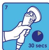
Nel caso di vasca con idromassaggio: collocare l'erogatore nella porta di iniezione. Tenere premuto il grilletto. L'acqua deve fuoriuscire da tutte le bocchette per l'aria/ugelli.
