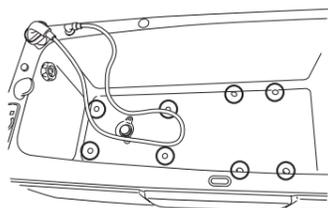
El efecto de masaje se obtiene inyectando aire a través de toberas en el agua de baño. El tratamiento máximo recomendado con el sistema Air Spa es de 15 minutos.
