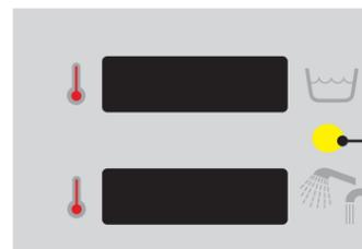
La protección contra quemaduras detiene el agua si se detecta un nivel de temperatura peligroso.
