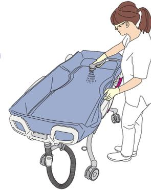
Промойте все детали холодной водой до полного удаления видимых остатков дезинфицирующего средства. Начните с верхней части матраса, спускаясь вниз к колесам. Промойте каталку под матрасом.
