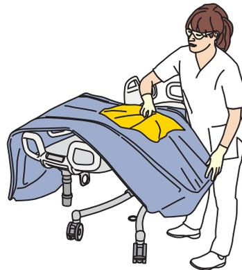
Обработайте нижнюю сторону матраса, опорные пластины и внешнюю сторону верхнего сливного патрубка.
