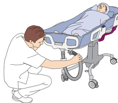
Coloque a parte traseira da saída do escoamento inferior no suporte ou fixe o escoamento inferior ao escoamento superior.
