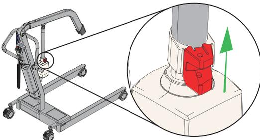
Für den Fall eines Ausfalls der Handbedienung oder eines Fehlers am Steuergerät befindet sich am Stellantrieb ein roter Hebel.
