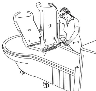
以水噴淋，並以乾淨的抹布擦除沐浴抬升器、底座及所有拆除零件上的所有殘餘消毒劑痕跡。應偶爾以自來水沖洗抹布。
