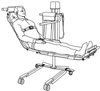
Heben Sie den Bolero Liegelifter auf eine Höhe an, die es ermöglicht, ihn über das Bett zu positionieren.
