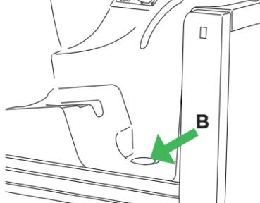
Lo scarico si chiude solo quando la porta viene sollevata in posizione superiore (A).
