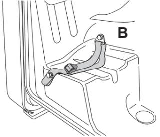
Allacciare la cintura di sicurezza secondo la figura A o B. Regolare la lunghezza tirando l'estremità della cintura di sicurezza tramite il gancio.
