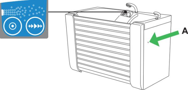
Sollevare la porta in posizione superiore e riempire la vasca sopra il pulsante del sensore di alto livello dell'acqua (A).
