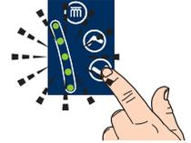
**Verlängern:** Komfort-Anzeigen blinken + Tonfolgen: Beliebige Komfort-Taste drücken, um 5 Minuten zu verlängern. Maximal 30 Minuten.
