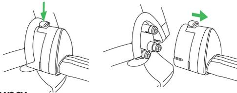
**Aktivierung:** Den Knopf herunterdrücken und am Anschluss der Schlauchleitungen ziehen. Die Matratze hält für bis zu 12 Stunden den Druck.
