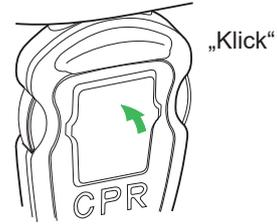
**Reset:** Drücken Sie so lange auf die Vorderseite der CPR-Einheit, bis sie einrastet.
