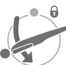
**Posizione Trendelenburg** - Questo pulsante consente di abbassare il lato testa del pianale (posizione Trendelenburg). Durante la corsa di ritorno da una posizione inclinata, il pianale si arresta brevemente in posizione orizzontale (nessuna inclinazione).
