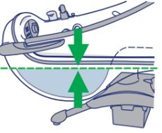
Il riempimento si ferma quando il pozzetto è pieno.
