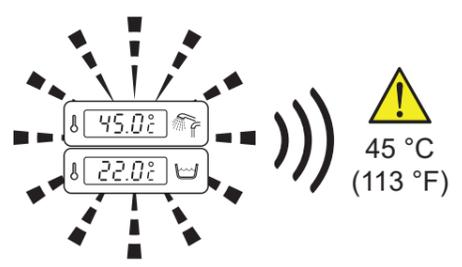
La temperatura parpadea y emite un pitido. El agua se detiene automáticamente al cabo de 10 segundos.
