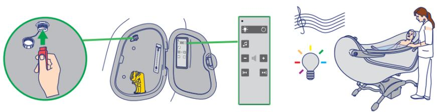
Desenrosque la tapa e inserte el dispositivo USB.
