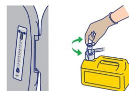
Determinare il rapporto di miscelazione della disinfezione: spruzzare il disinfettante nella vasca mentre si controlla il flussometro all'interno della cover e regolare la manopola sul tubo di aspirazione se necessario.
