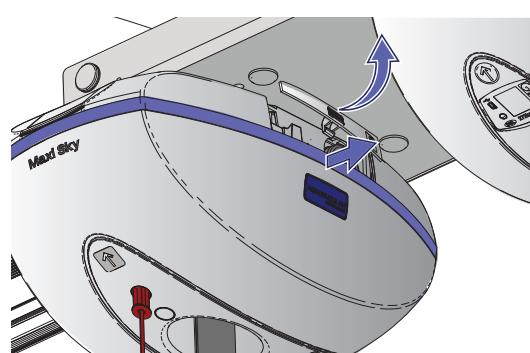
Deschideți ușile mici pentru a avea acces la mecanismul de coborâre al fiecărui elevator suspendat.
