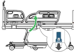
Seitengitter erhöhen und verriegeln.
