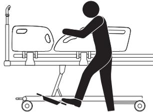
Nutzen Sie zur Unterstützung des Transports den Elektroantrieb.
