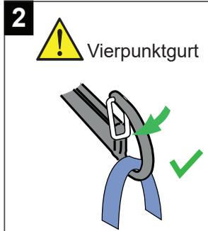
Haken Sie die Befestigungsschleife in den Aufnahmehaken ein. Vergewissern Sie sich, dass die Sicherheitsverriegelung geschlossen ist.
