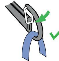
Haken Sie die Befestigungsschleife in den Aufnahmehaken ein. Vergewissern Sie sich, dass die Sicherheitsverriegelung geschlossen ist.
