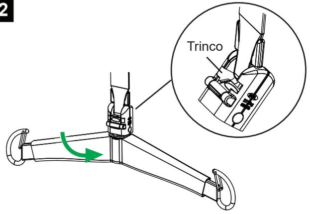
Mova a barra de suporte para encaixar o gancho no pivô. Rode a barra de suporte para a posição correta. Certifique-se de que o trinco do Quick-Connect está fechado.
