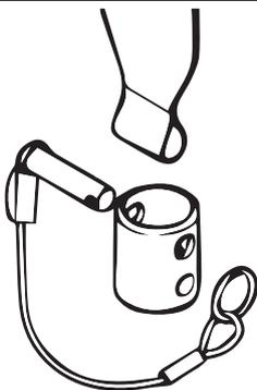
Insira a extremidade da extensão no acessório da barra de suporte. Insira o pino da manilha através do acessório e do laço na extremidade da extensão.
