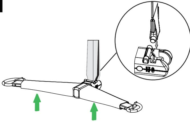
Alinhe o trinco Quick-Connect da barra de suporte a um ângulo de 90 graus com o gancho. Introduza o gancho no Quick-Connect.
