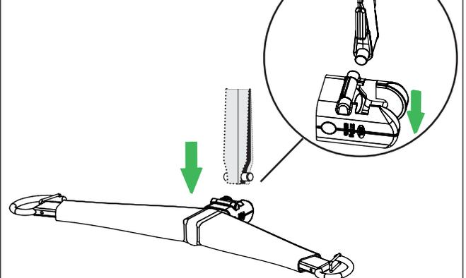
Tirer le berceau vers le bas à un angle de 90 degrés pour le retirer du Quick-Connect.
