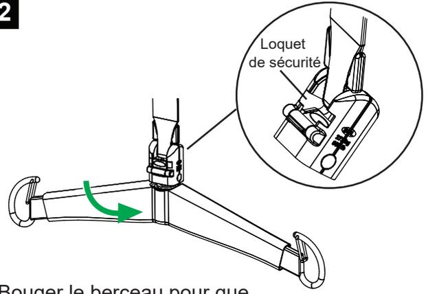
Bouger le berceau pour que le crochet entre en prise avec le pivot. Faire tourner le berceau jusqu'à ce qu'il soit en position. S'assurer que le loquet Quick-Connect est fermé.
