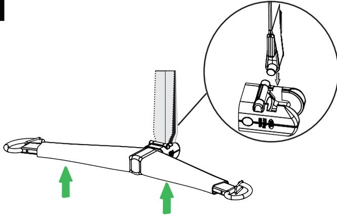
Aligner le loquet Quick-Connect du berceau à un angle de 90 degrés par rapport au crochet. Insertion du crochet dans le dispositif Quick-Connect.
