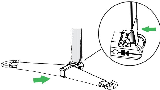
Bouger le berceau d'un angle de 90 degrés pour dégager le crochet du pivot.
