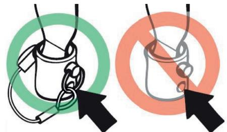
Fixer la goupille de blocage avec la bague fendue.
