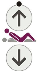
Il pulsante *Bio-Contour "freccia in su"* consente di sollevare contemporaneamente lo schienale e la sezione femorale. Il sollevamento della sezione femorale impedisce al paziente di scivolare sul letto
