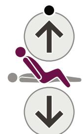
ปุ่ม เก้าอี้อัตโนมัติชี้นี้ จะยกส่วนพนักพิงและต้นขาขึ้นในเวลาเดียวกัน โดยจะหยุดเคลื่อนที่เมื่อพนักพิงทำมุม  $45^\circ$  กดปุ่มนี้ค้างไว้ได้ต่อไปเพื่อลดระดับแผ่นรองเบาะส่วนปลายเดียว เพื่อให้เกล้ายเป็นท่านั่งเก้าอี้
