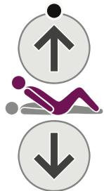
С помощью кнопки «Биоконтур вверх» одновременно поднимаются секции спины и бедер, обеспечивая сидячее положение пациента; поднятая секция бедер предотвращает сползание пациента с медкровати.
