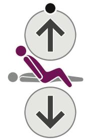
С помощью кнопки «Автокресло вверх» одновременно поднимаются секции спины и бедер, с паузой при достижении секцией спины угла наклона 45°. Продолжайте удерживать кнопку в нажатом положении, чтобы опустить ножной конец матрасной платформы в положение «кресло».
