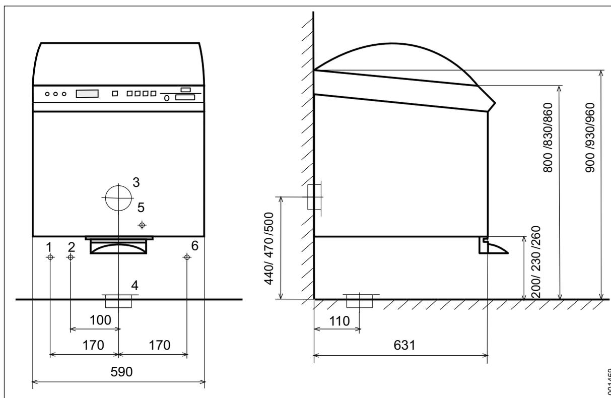
Figura 3. Instalação da máquina vertical
