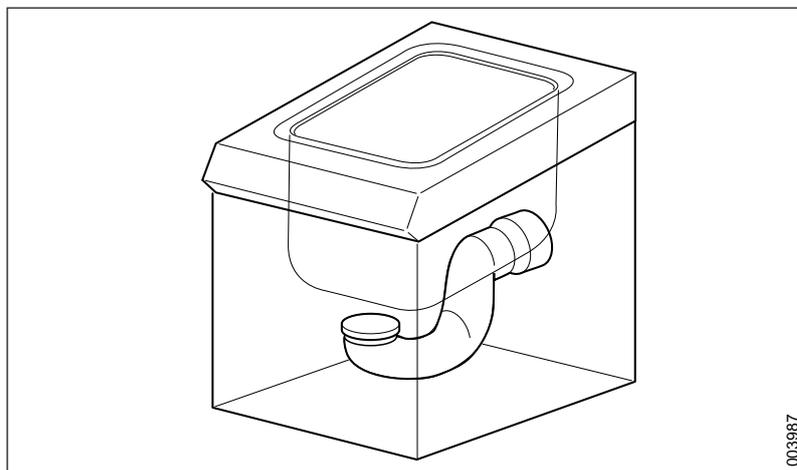
Figura 7. Ligação de drenagem P numa parede
