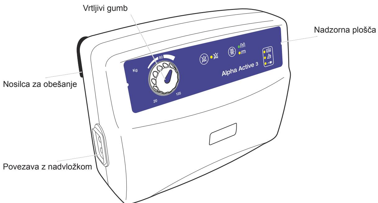
Krmilni gumbi so na sprednji strani črpalke. Alarmni sistem razlikuje med običajnim delovanjem in pravimi sistemskimi napakami. V primeru alarmova na sprednji strani črpalke zasveti indikator in vklopi se zvočno opozorilo.
