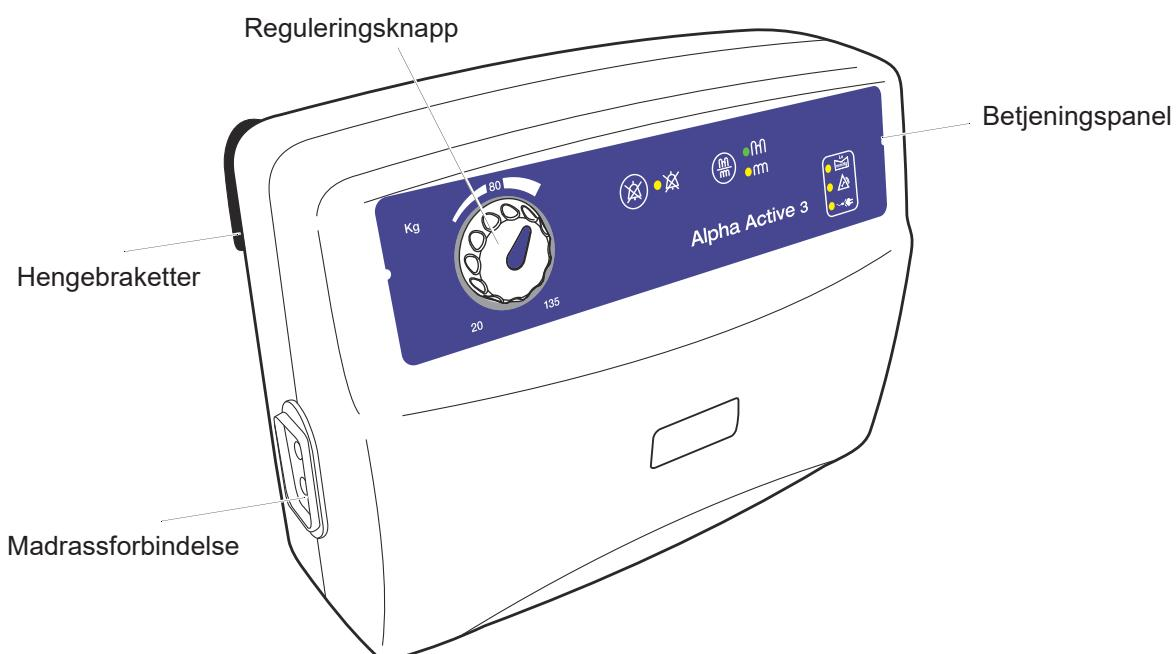
Betjeningselementene er plassert foran på pumpen. Et alarmsystem skiller mellom normal drift og reelle systemfeil. Hvis det oppdages en alarmsituasjon, tennes en lampe på forsiden av pumpen, og et lydvarsel høres.
