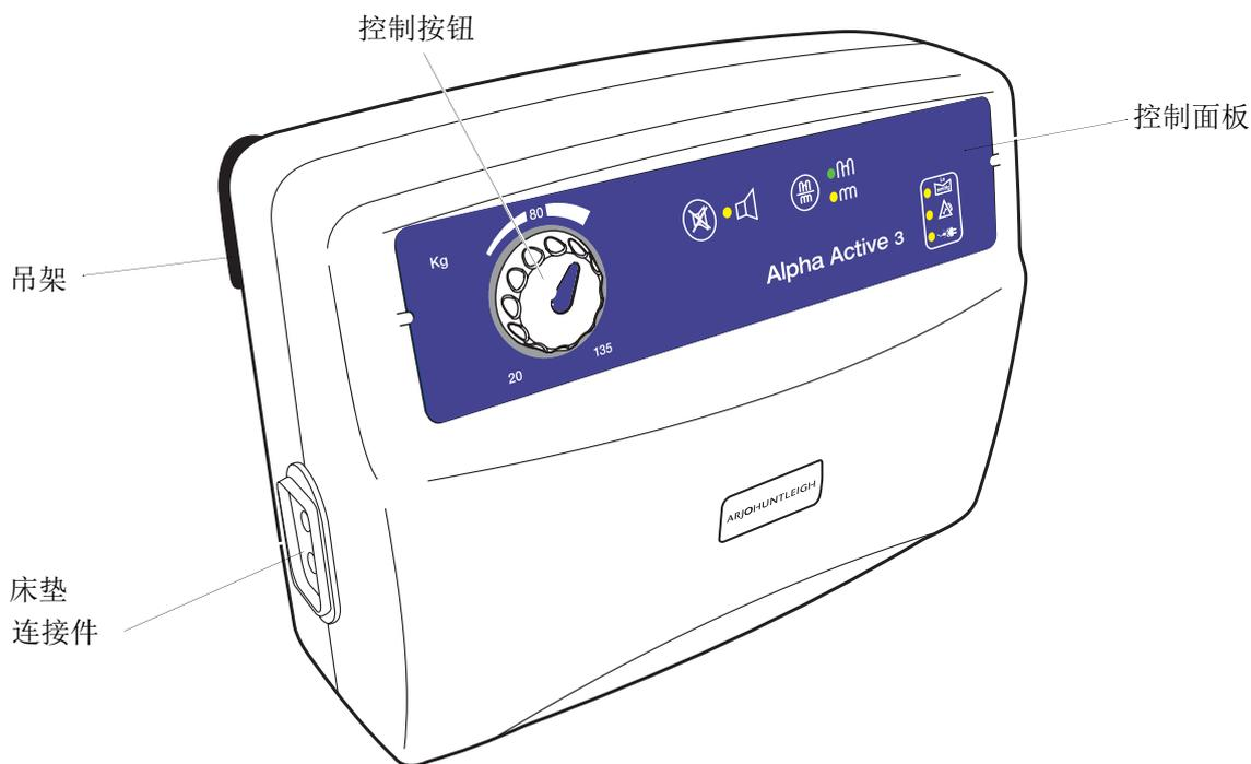
这些控件位于气泵的前面。指示系统可区分正常运行和实际系统故障。如果检测到提示状况，气泵前面的指示灯将亮起，并响起提示声。
