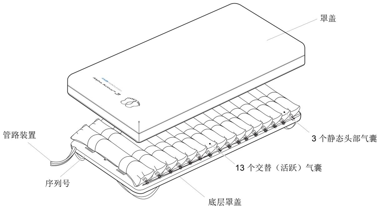
**可拆卸罩盖** 标准外罩包括了双向伸展的聚氨酯 (PU) 涂层织物外罩，通过拉链结合到耐用的尼龙底座。拉链上配备罩片，防止污物进入，并且易于拆卸，以便进行清洁。
