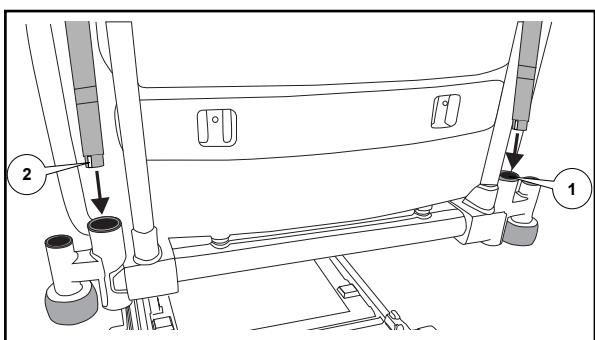
ベッド頭部先端の各ソケット(1)にリフト用ポールを挿入し、ポールの水平部分をベッド中央に設置します。
