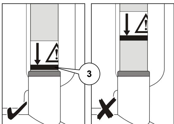
Dacă suportul de ridicare este montat corect, linia indicatorului (3) se va afla la același nivel cu partea superioară a soclului.
