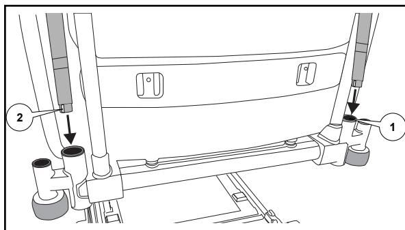
Εισαγάγετε τους αναρτήρες έλξης σε κάθε υποδοχή (1) στο άκρο κεφαλής της κλίνης, με το οριζόντιο τμήμα του στύλου να βρίσκεται επάνω από το κέντρο της κλίνης.
