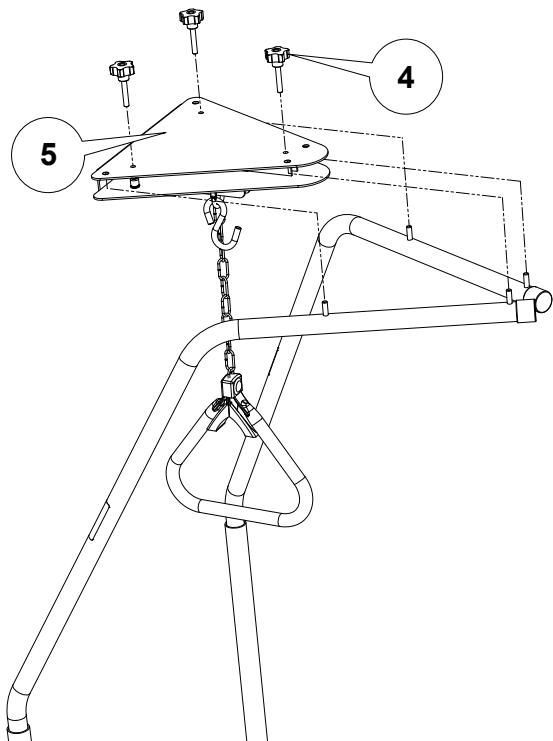
Pour régler la hauteur de la poignée au-dessus du lit : placez l'anneau de la chaîne désiré sur le crochet en « S » prévu à cet effet.
