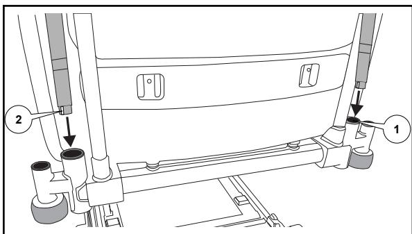
Setzen Sie die Aufrichthilfe so in jede der beiden Aufnahmen (1) am Kopfteil des Betts, dass sich der waagerechte Teil der Aufrichthilfe über der Mitte des Betts befindet.
