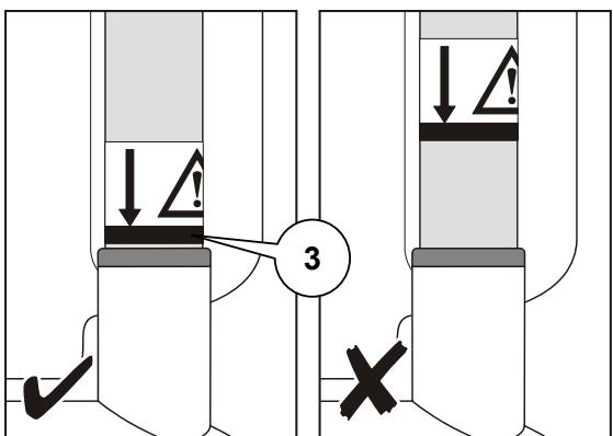
リフト用ポールが正しく設置できたら、インジケーターライン(3)とソケット上部とが平行になります。
