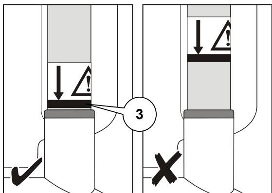
正确安装吊杆时，指示线 (3) 将与槽口顶部齐平。
