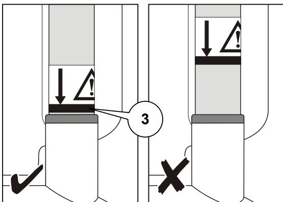
Quando o suporte de elevação estiver corretamente instalado, a linha indicadora (3) estará nivelada com a parte superior do encaixe.
