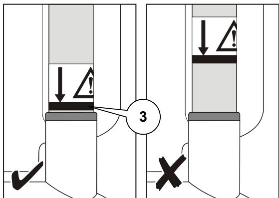
När däverten är korrekt installerad är indikatorlinjen (3) jäms med hylsans ovansida.
