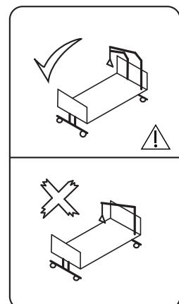
Πριν την εγκατάσταση των αναρτήρων έλξης, ελέγχετε ότι οι υποδοχές αναρτήρων έλξης της κλίνης δεν έχουν υποστεί καμία ζημιά.
