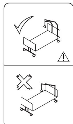
*Para reduzir o risco de retenção do paciente, o painel da extremidade da cabeceira deve permanecer sempre colocado enquanto os suportes de elevação estiverem instalados na cama.*
