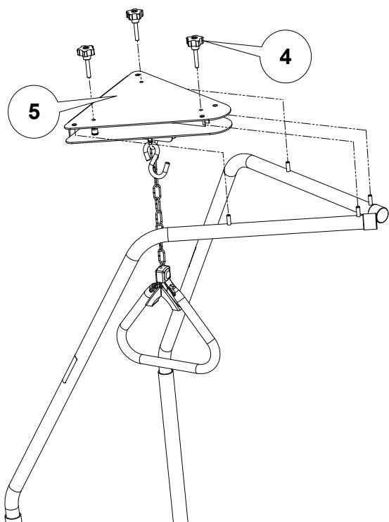
Ajustați înălțimea mânerului deasupra patului: prindeți inelul dorit de pe lanț pe cârligul în formă de „s”.
