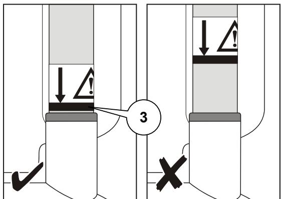
При правильной установке стойки для подъема линия-указатель (3) будет находиться на уровне верхней части гнезда.
