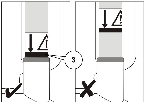
Quando l'asta sollevamateli è installata correttamente, la linea indicatrice (3) è allo stesso livello della parte superiore del foro.
