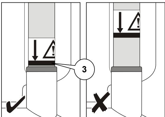
Als de papegaaipaal juist is geïnstalleerd, bevindt de indicatorlijn (3) zich op gelijke hoogte met de bovenkant van de houder.
