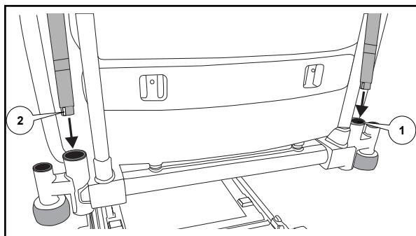
Insérez les potences dans chaque support (1) au niveau de la tête du lit, avec la partie horizontale positionnée au-dessus du centre du lit.
