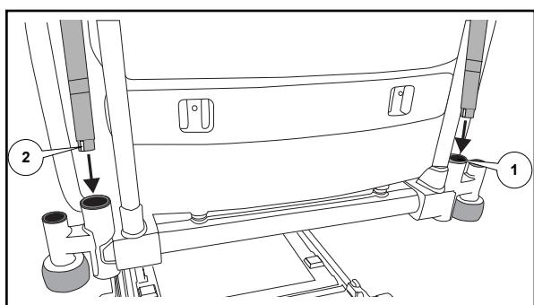
将吊杆插入到位于床头端的各个插孔 (1) 内，使吊杆的水平部位位于病床中部上方。
