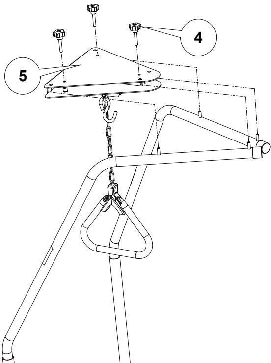
Para ajustar la altura del asa sobre la cama: presione la cadena de bucle que deseé en el gancho en S que se proporciona.
