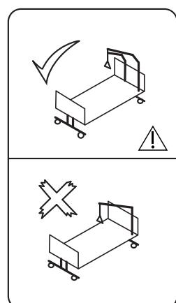
*Kontrollera innan dävertarna monteras att sängens däverthylsor inte är skadade på något sätt.*
