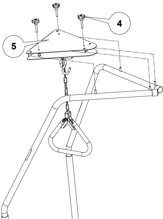
สำหรับการปรับความสูงของที่จับเหนือเตียง: กดห่วงสายโซ่ที่ต้องการเข้ากับตะขอรูปตัว “S” ที่ให้ไว้
