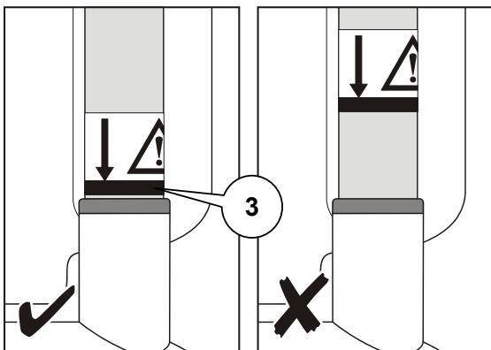
Kiedy wisięgnik jest prawidłowo zainstalowany, linia pomocnicza (3) powinna być zrównana z górną krawędzią gniazda.
