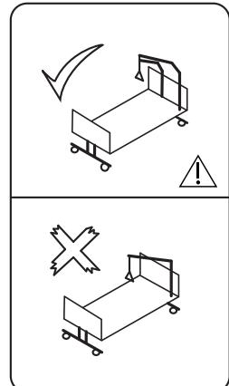
患者が挟み込まれる危険を防止するため、リフト用ポールがベッドに取り付けられているときは、常に、頭部先端パネルを装着した状態にします。
