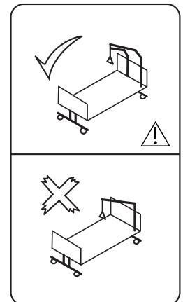
安装吊杆之前，首先检查并确定病床的吊杆插孔未受到任何损坏。
