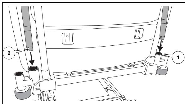
Вставьте стойки для подъема в соответствующие гнезда (1), расположенные в головной секции кровати, а горизонтальную часть стойки разместите над центром кровати.
