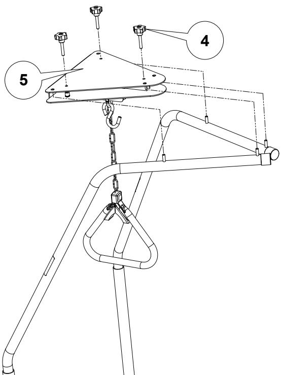
ベッド上のハンドルの高さを調整するには、目的のチェーンループを、「S」フックに押し付けます。
