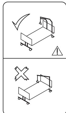
*Для снижения риска защемления частей тела пациента при установленных на кровать стойках для подъема необходимо, чтобы панель головной секции кровати была закреплена.*
