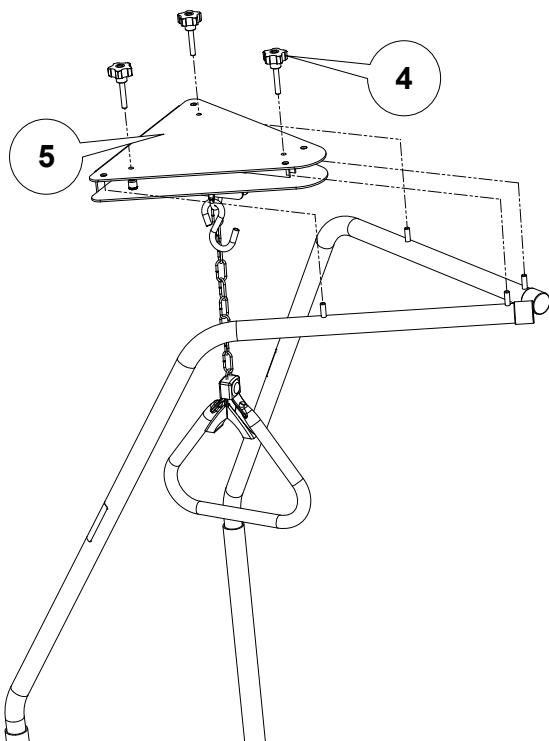
Aby wyregulować wysokość uchwytu nad łóżkiem: wcisnąć odpowiednią pętlę łańcucha na dostarczony hak „s”.
