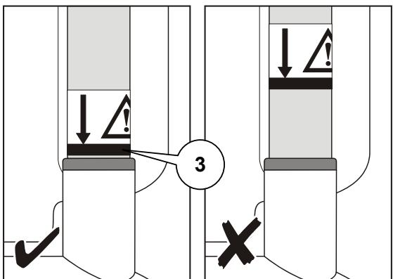
Si el trapecio se ha instalado correctamente, la línea indicadora (3) deberá situarse al mismo nivel que la parte superior del hueco.
