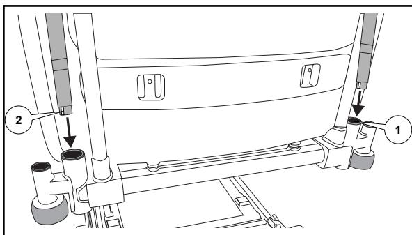
Insira os suporte de elevação em cada encaixe (1) na extremidade da cabeceira da cama, com a parte horizontal do suporte acima do centro da cama.
